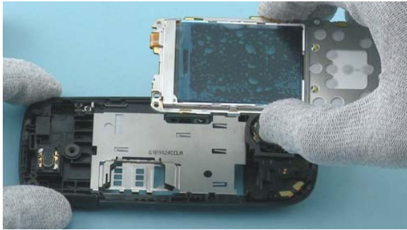
13) Remove the ENGINE MODULE.
